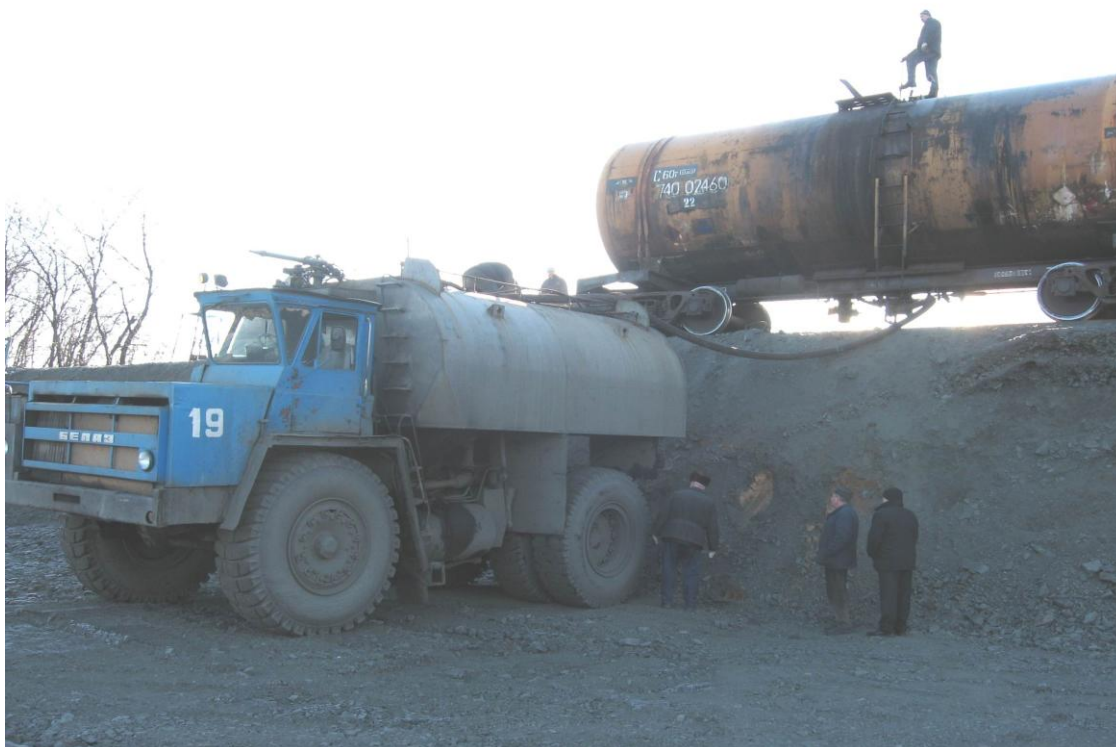
Рисунок 4.1 Заправка гідромонітора розчином бішофіта
