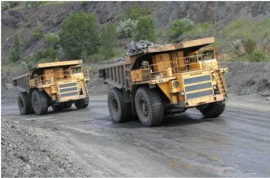
Рисунок 2.16 Стан дорожнього покриття після нанесення бішофіту
