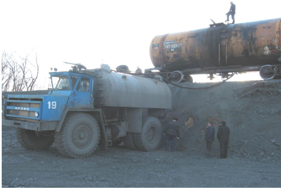
Рисунок 2.13 Заправка гідромонітора бішофітом
