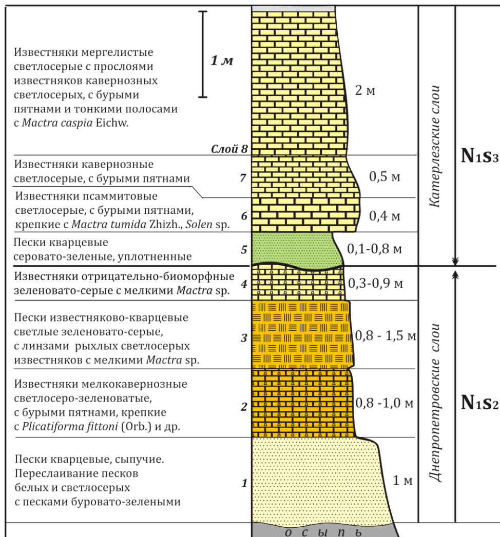
Рис. 3. Геологический разрез западного борта карьера Визирка-3 и стратиграфическое расчленение вскрытой им осадочной толщи.
