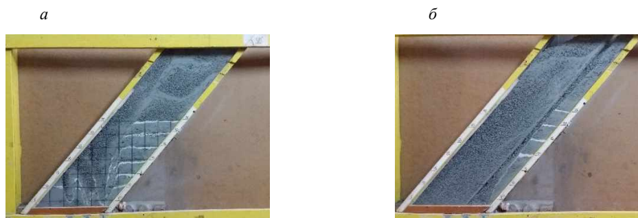
Рис. 8. Вигляд лабораторної моделі по завершенню очисних робіт. а - випуск традиційною технологією з доставних штреків
