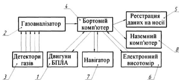
Рис. 2. Принципова схема БПЛА
