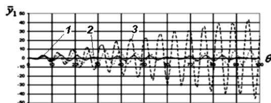
Рис.3. Зависимость колебаний первой гармоники штанги от параметра времени \theta : при 1 – \varepsilon=0,8 ; 2 – \varepsilon=0,9 ; 3 – \varepsilon=0,99
