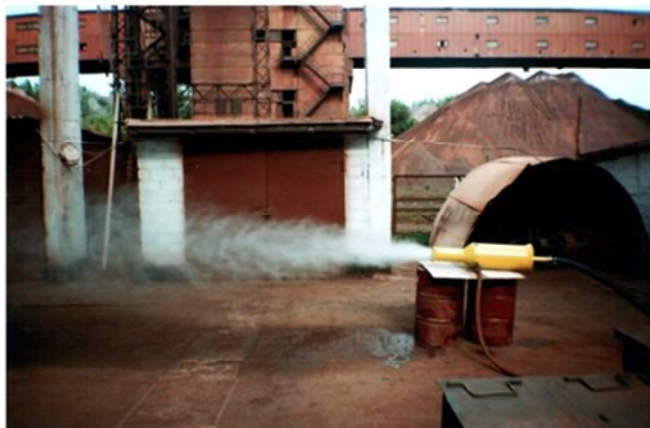
Рис. 3. Випробування установки на промисловому майданчику шахти ім. Фрунзе ПАТ «Суха Балка»
