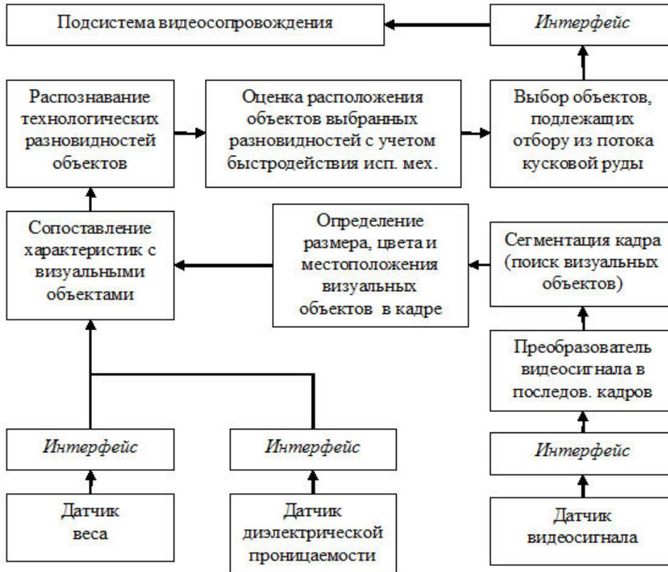
Рисунок 1 – Формирование управление в системе сортировки кусковой руды с учетом ограниченности быстродействия исполнительного механизма
