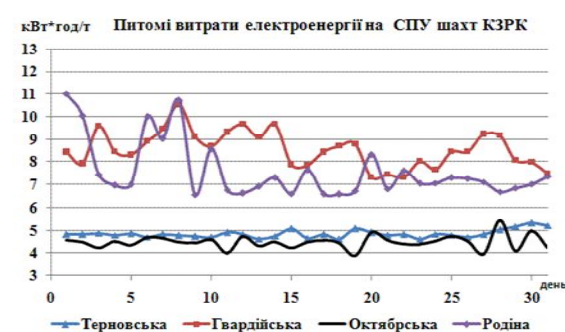
Рис.4. Графіки питомих витрат електроенергії на СПУ шахт КЗРК
