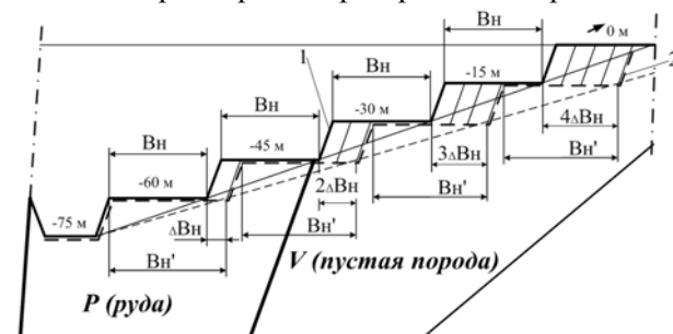
Рис. 1 Схема для определения взаимосвязи вскрышных работ и производительности карьера: 1 (-) и 2 (- -) – положение рабочего борта карьера при работе с производительностью по руде A_p и A_p+\Delta A_p ; \Delta B_n - увеличение нормативной ширины рабочей площадки при увеличении производительности карьера по руде на \Delta A_p ; B'_n - нормальная ширина рабочей площадки при работе карьера с производительностью по руде A_p+\Delta A_p
