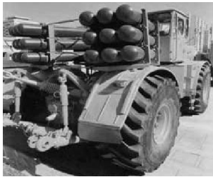
Рис. 1. Зовнішній вигляд трактора К-701 з газобалонною установкою
