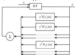
Рис. 1. Рекурсивно-параллельная модель Гамерштейна:  $H(j\omega)$  - комплексный коэффициент передачи;  $X(j\omega)$  - входная величина;  $Y(j\omega)$  - выходная величина;  $j = \sqrt{-1}$ ;  $\omega$  - угловая частота колебаний входного сигнала
