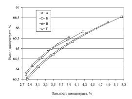
**Рис. 3.** Зависимость выхода концентрата от его зольности при разных вариантах схем гравитационного обогащения
