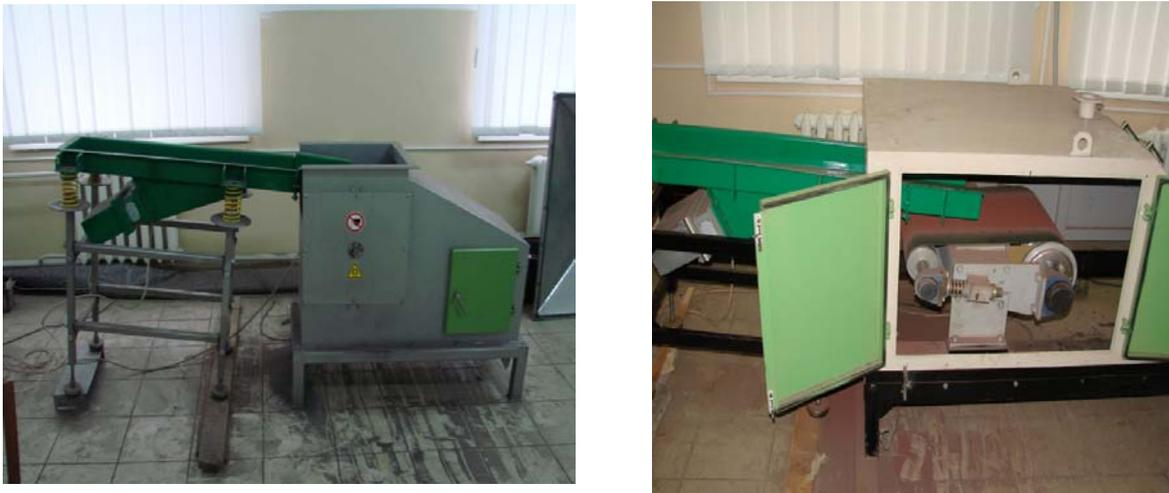
Рис. 1. Магнитные сепараторы: BC-31,5/30-Н; IPC-22/30-Р
