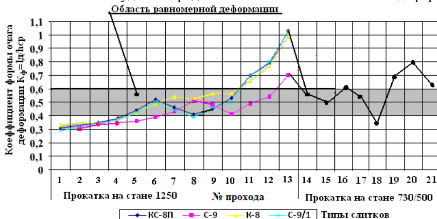
Рис. 1. Распределение фактора формы очага деформации по проходам при прокатке, различных по форме и массе слитков на блюминге 1250 и блюмов на НЗС 730/500
