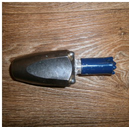
Рис.2. Штыревая комбинированная коронка-расширитель
