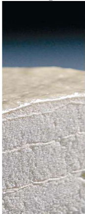
Рис. 3 «Extrafoam» системи напилення ізоціануратів (PIR) (фото)
