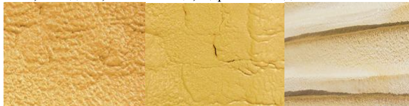
Рис. 1. Теплоізоляція на основі пінополіуретану (фото)
