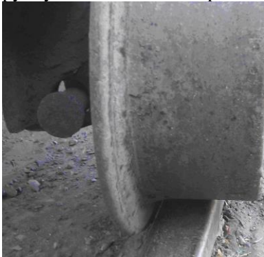
Рис. 1. Руйнування провусини кріплення колісної вісі
