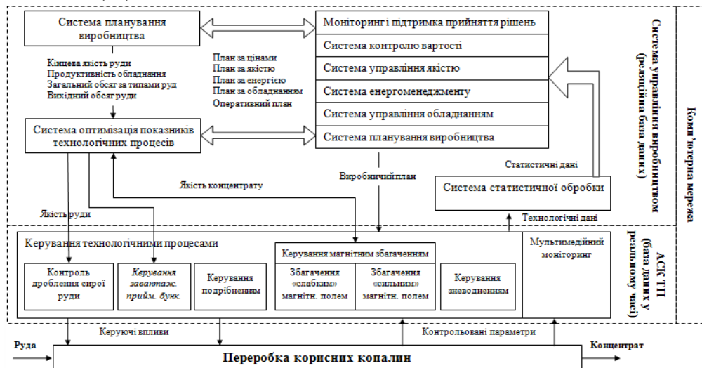
Рис. 2. Структура системи керування процесом виробництва для оптимізації показників переробки руди
