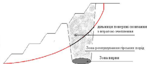
Рис. 2. Схема до розрахунку стійкості борту кар'єру підробленого підземними гірничими виробками
