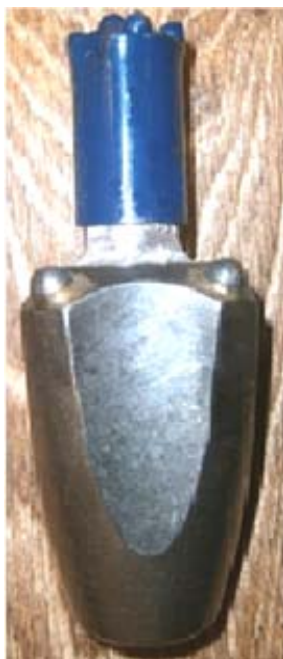
Рис. 4. Штыревая комбинированная коронка-расширитель
